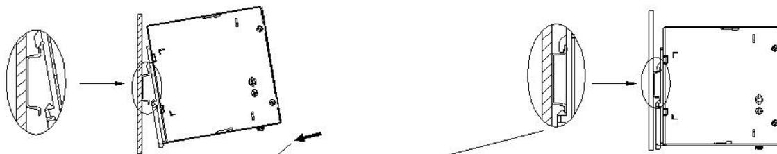
②把产品本体垂直TS35导轨方向推, 直到听到卡扣卡入导轨的声音;
